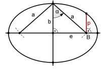
Die lineare Exzentrizität e markiert man als Abstand der Brennpunkte vom Zentrum. Im rechtwinkligen Dreieck wird deutlich, dass e ein absolutes Maß für die Abweichung der Ellipse vom Kreis ist. Je kleiner e, desto weniger unterscheiden sich a und b und desto kreisähnlicher ist die Ellipse. Für e=0 fallen die beiden Brennpunkte im Kreismittelpunkt zusammen.
