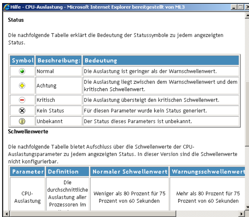
Abbildung 31: CPU Auslastung - Hilfe 2
