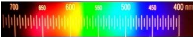
Spektrum einer Glühlampe im Spektroskop gesehen
