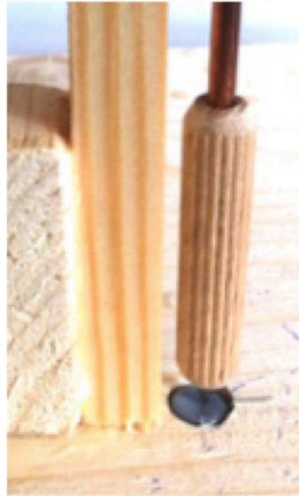
Wenn man Schweißdraht mit 4mm Durchmesser nimmt, kann man als Verbindungsstück auch vorgefertigte Distanzhülsen nehmen, die 4 mm Innendurchmesser haben.
