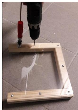
1. Holzrahmen aus den Teilen (B) und den Holzschrauben (E) erstellen. Hier bietet sich ein Vorbohren an, da das Holz sonst reißen könnte.
