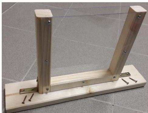
3. Den so entstandenen Holzkasten mittig auf dem Holzfuß (C) anbringen und mittels Metallwinkel (F) und Holzschrauben fixieren.
