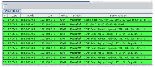
Abbildung 1: Datenaustauschfenster bei einem Ping-Befehl
